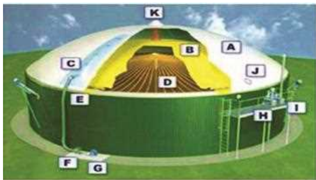
A: külső membrán B: belső membrán C: légbefúvó rendszer D: hevederek, E: lehgonyzó sín F: visszacsapó szelep, G: kompresszor H: vákum szelep, I: túlnyomás szelep, J: kémlelő, K: ultrahangos szintmérő
