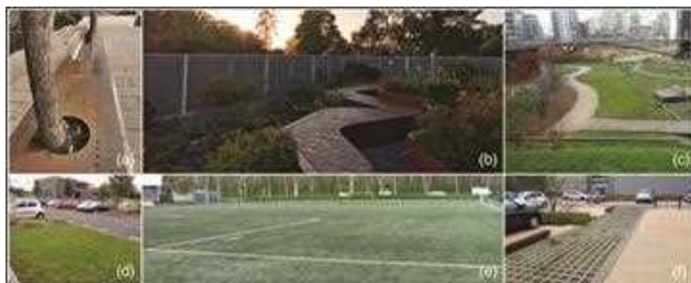
3. ábra Példa olyan csapadékvíz-gazdálkodási infrastruktúrára, amelynek fő funkciója nem kapcsolódik a vízgazdálkodáshoz: a) utcabútor (Melbourne, Ausztrália), b) tető (Burnley, Ausztrália), c) közpark (Párizs, Franciaország), d) parkoló (Villeurbanne, Franciaország), e) futballpálya (Villeurbanne, Franciaország) és f) gyalog- vagy kerékpárút (Villeurbanne, Franciaország).
