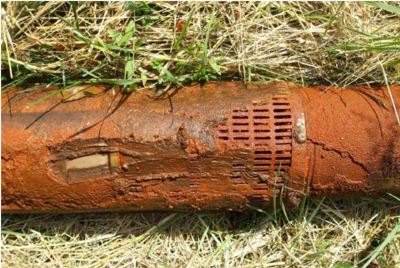
8. és 9. kép: Vas- és mangán-oxid csapadék a kútból kiépített búvár-szivattyún (BÁCSVÍZ Zrt., 2009 és 2015)
