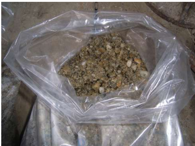
3. kép: A kutak által szűrőzött vízadó réteg jellemző szemcseösszetétele a T-13. jelű kút szelvényében
