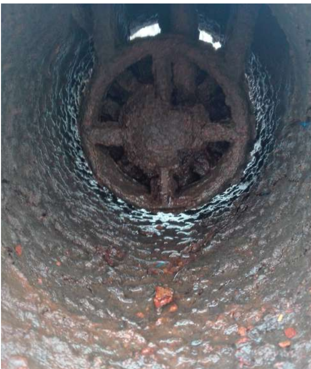
8. és 9. kép: Vas- és mangán-oxid csapadék a kútból kiépített búvár-szivattyún (BÁCSVÍZ Zrt., 2009 és 2015)
