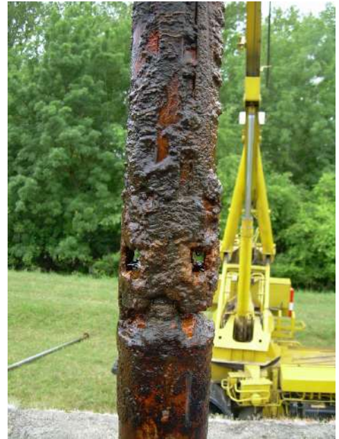
8. és 9. kép: Vas- és mangán-oxid csapadék a kútból kiépített búvár-szivattyún (BÁCSVÍZ Zrt., 2009 és 2015)
