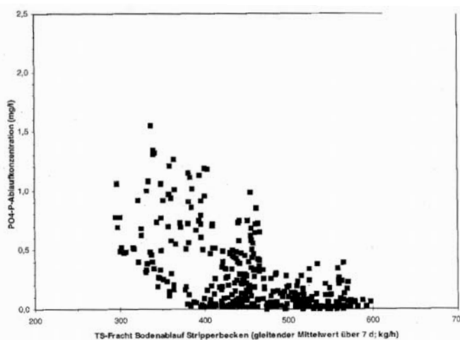
3. ábra: A PO_4 -P elfolyási koncentráció összefüggése a mellékáramból az eleveniszapos medencébe visszavezetett sz.a. tartalommal
