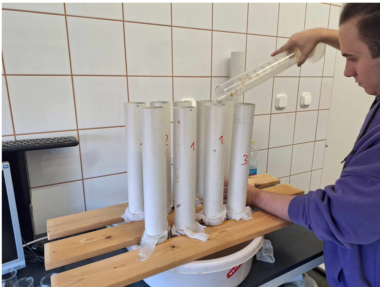
2. ábra: Az olaj és víz keverékét tartalmazó folyadék átengedése a gyapjún
